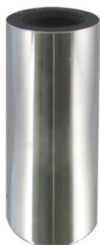
Рисунок 17 - Общий вид сменных вставок абсолютно черного тела
